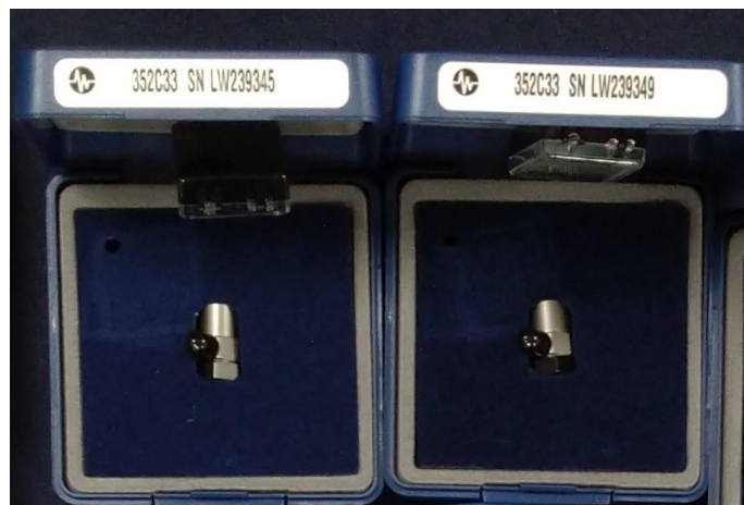
Uniaxial accelerometers (2 Nos.)
