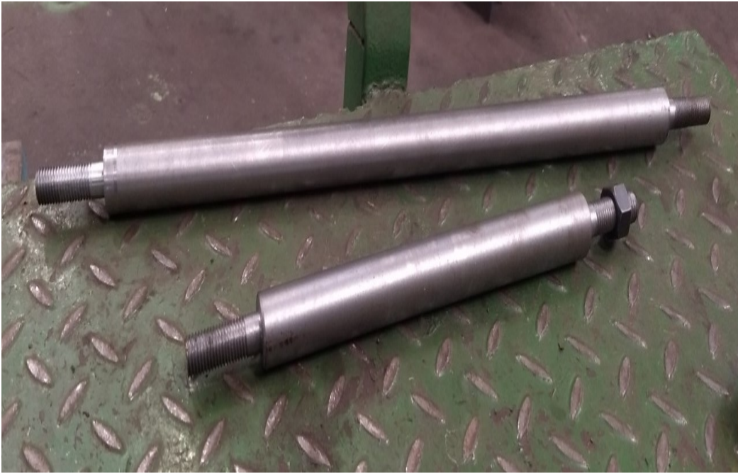
Fig. 4.17 Fabricated guide rod
